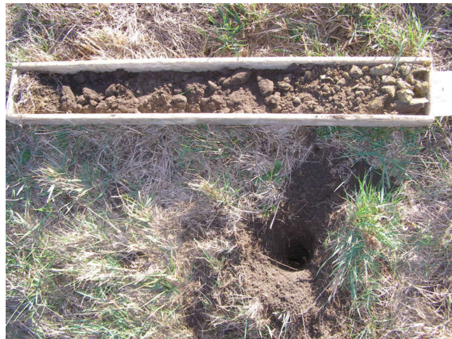
Souvislý sondážní výnos na sondě VS2 (00,00 - 01,00 m) - km 0,214
