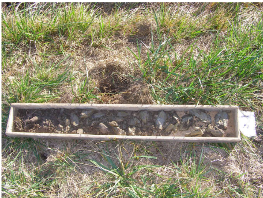
Souvislý sondážní výnos na sondě VS3 (00,00 - 01,00 m) - km 0,295
