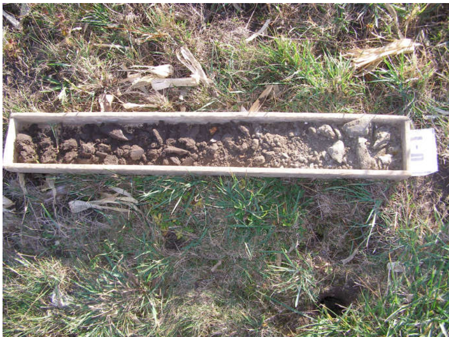
Souvislý sondážní výnos na sondě VS1 (00,00 - 01,00 m) - km 0,062
